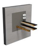
4. Schottschild deutlich mit einem Permanentmarker ausfüllen und dauerhaft neben dem Schott einseitig anbringen. Nach Abtrocknen der Mörtelreste, diese von Kabeln, Wänden und Böden entfernen, Flächen säubern einschließlich Entfernen der Abdeckfolien und ordnungsgemäßer Entsorgung.
