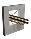
Schottmasse so einbringen, dass ein fester, dichter Anschluss zum Bauteil entsteht (Schottdicke mind. 240 mm).
